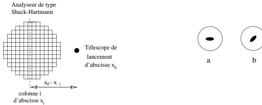
FIG. 3.7: Selon l'orientation de la tache laser sur la matrice de sous-pupilles, l'erreur de mesure des pentes sera identique sur les deux axes de mesure ou pas. Le schéma de gauche montre une configuration où la position selon l'axe des ordonnées est mesurée précisément alors que celle selon l'axe des abscisses est entachée d'imprécision. Le schéma de droite montre une configuration où les erreurs en abscisse et en ordonnée sont identiques.
