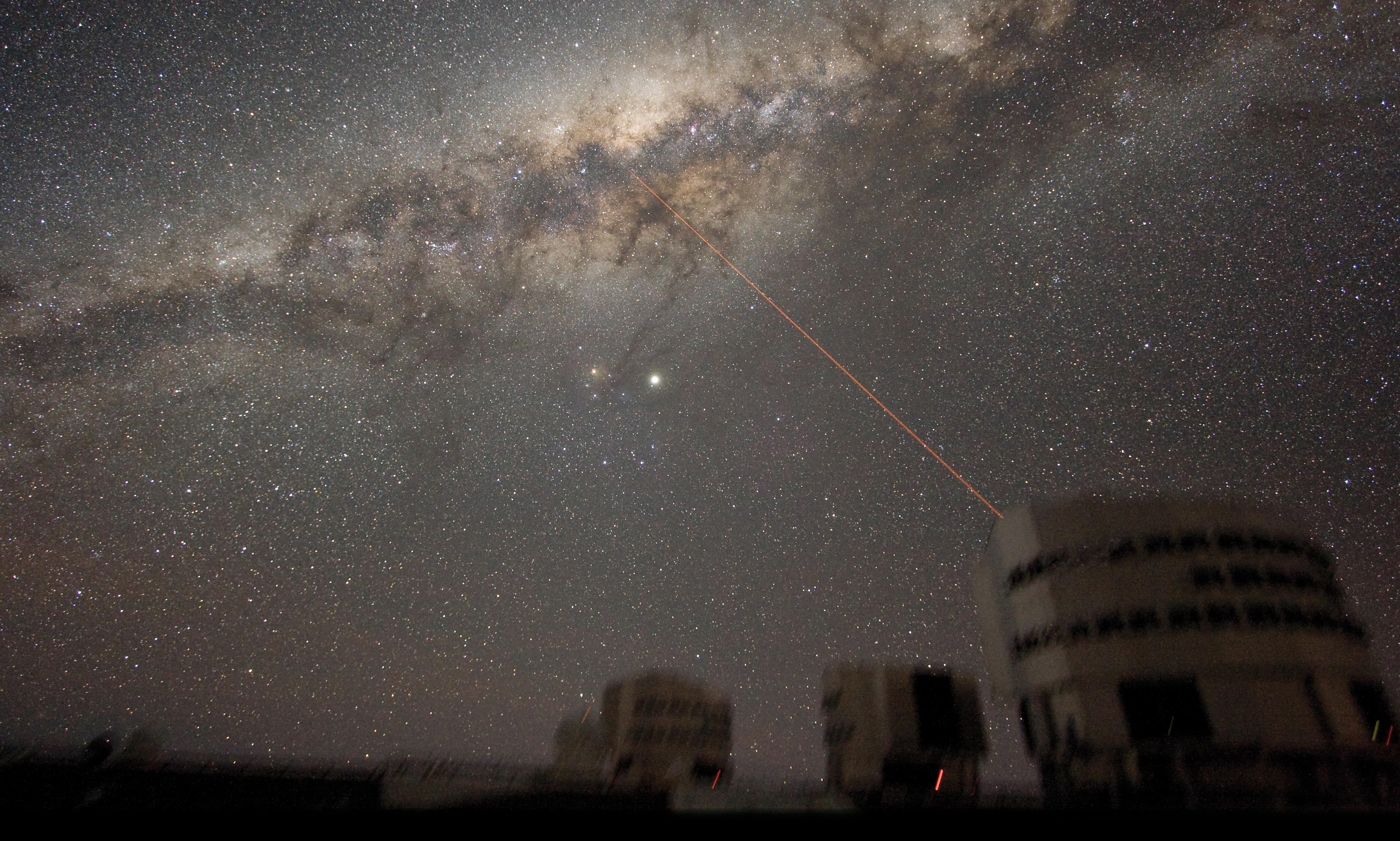
Una estrella artificial hacia el Centro Galáctico La Estrella Guía Láser del Very Large Telescope (VLT) apunta al centro de la Vía Láctea desde el telescopio Yepun. Esta estrella artificial es parte del sistema de óptica adaptativa, que corrige los efectos de la atmósfera terrestre, proporcionando una imagen final casi igual de nítida que la que lograríamos desde el espacio. Foto: Y. Beletsky/ESO
